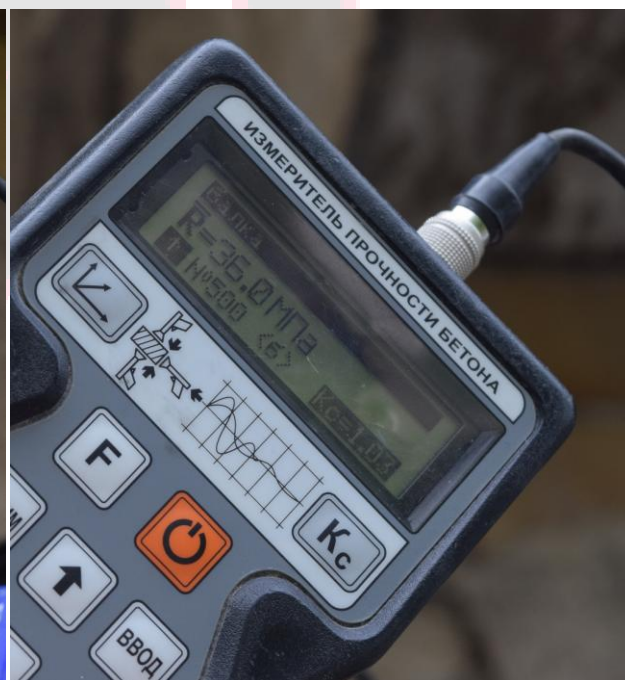
Фото 8. Показатель прочности бетона.
