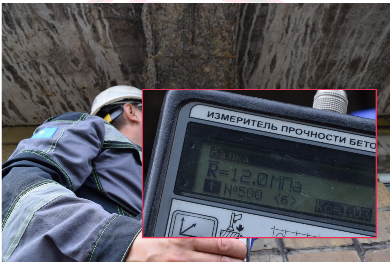
Фото 9. Показатель прочности бетона.
