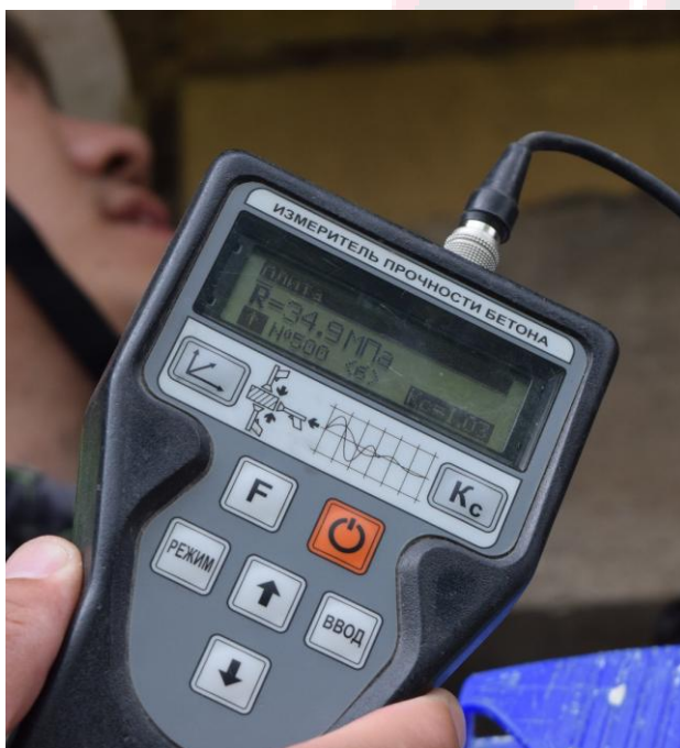
Фото 7. Показатель прочности бетона.
