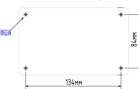
Преобразователь интерфейса (RS-485/USB) MP-251W1 (задняя сторона)
