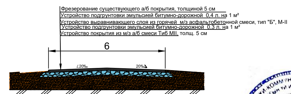
Конструктивный поперечный профиль дорожной одежды
